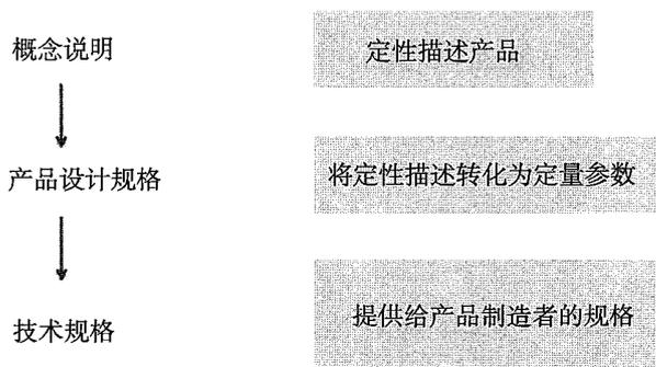
图 4.1 设计流程示意图
